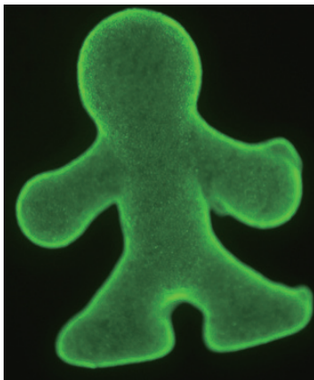
細胞をビーズ状に加工し 3次元の鋳型で高速に モールドされた細胞組織構造
